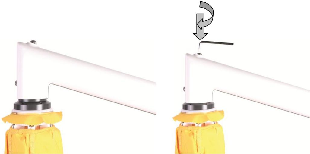
10. Öffnen Sie den Expander der Bespannung. Ziehen Sie das Schirmdach an den Speichen leicht auf, so dass der Innenraum zugänglich ist. Stecken Sie den Dorn axial in den unteren Verteilerflansch und verschrauben Sie diesen von unten mit einem 5-er Inbusschlüssel.
