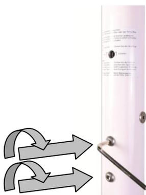
5. Stecken Sie die Handkurbel in die Getriebebohrung.
