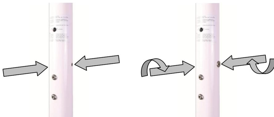
4. Fixieren Sie die beiden Linsenkopfschrauben, indem Sie diese mit einem 6-er Inbusschlüssel mit 54 Nm anziehen.
