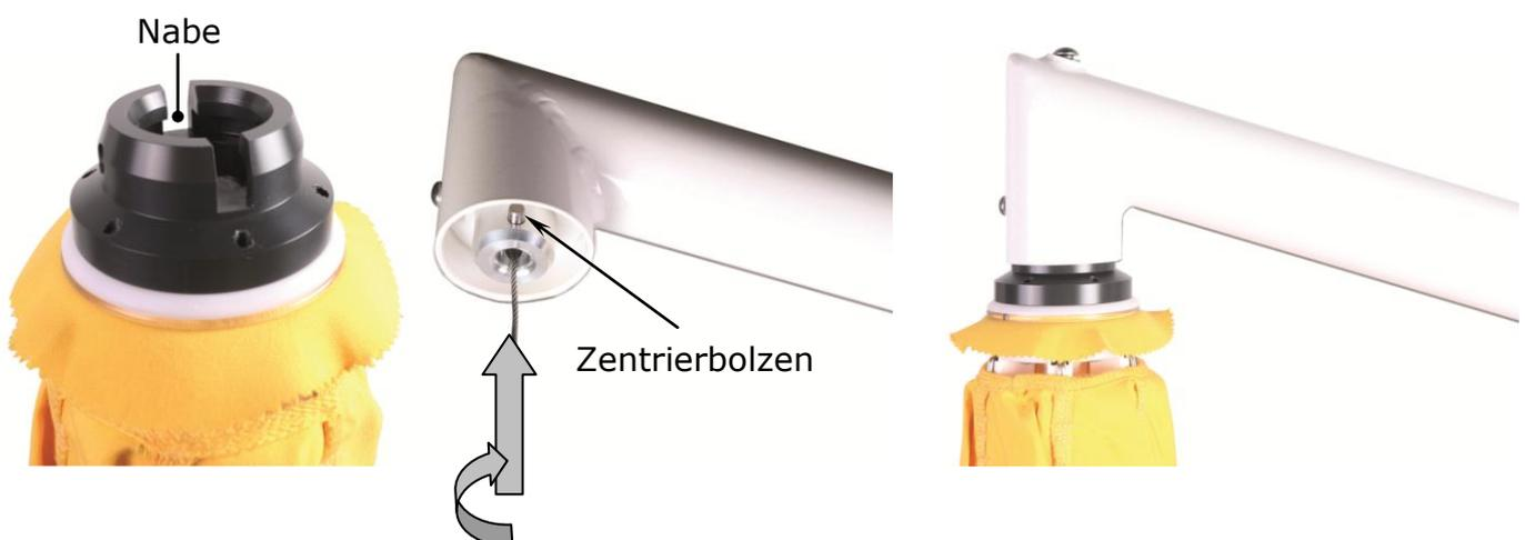
9. Fixieren Sie das Schirmdach im Kragarm, indem Sie mit einem 6-er Inbusschlüssel die Schraube am Kragarm mit 37 Nm anziehen.
